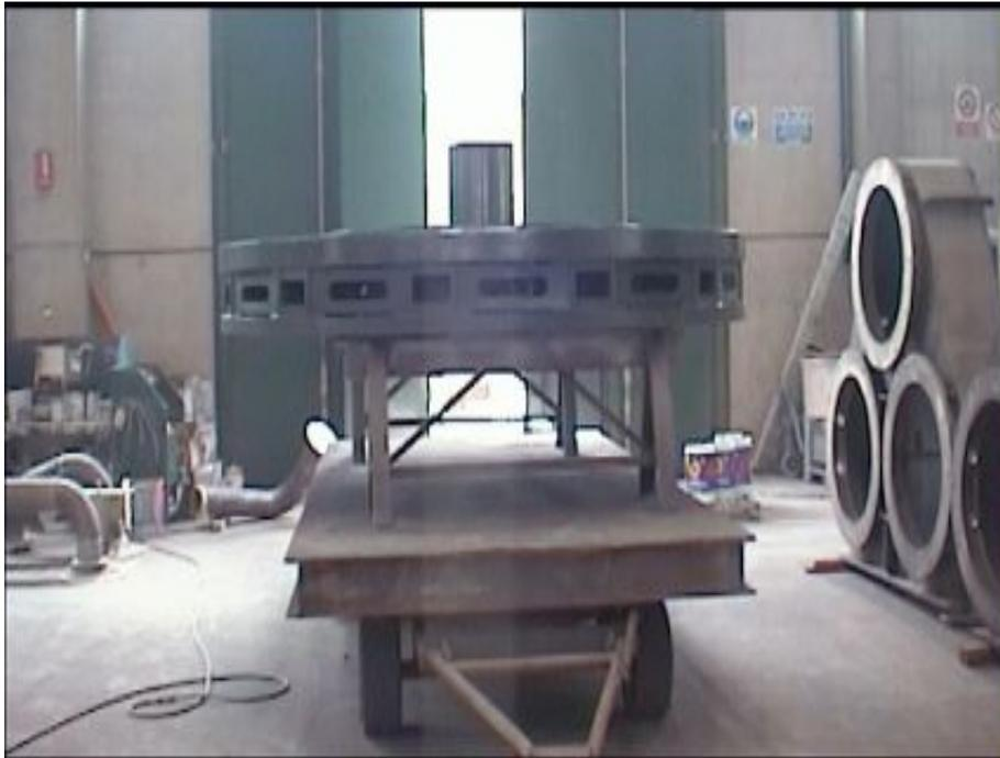
**Fig.5.d – Il baseplate completato (carpenteria)**
