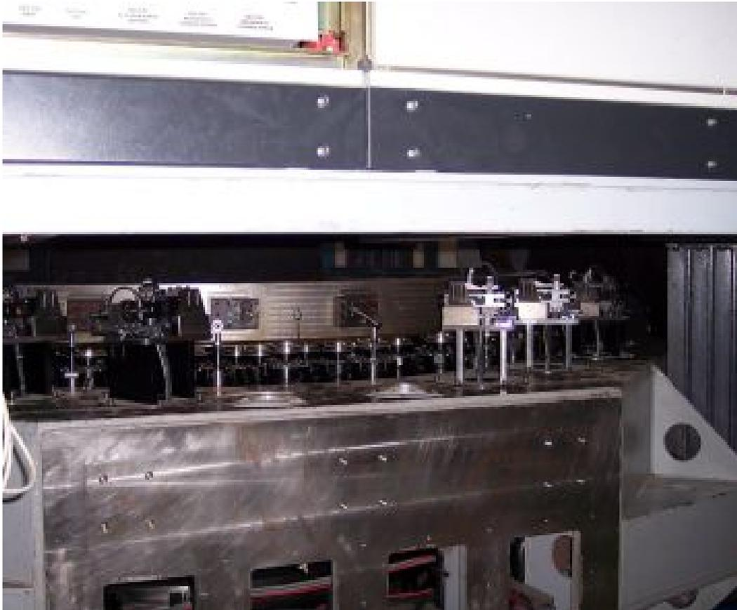
**Il dummy di M1 poggiato sugli attuatori assiali e fissato a quelli radiali. Il sistema è stato completamente testato nel 2004-2005 ed era in fase di test all'inizio del 2006 quando una delle collaboratrici formate dal sottoscritto ed operante sul sistema SW degli attuatori ha lasciato l'incarico per giusta causa (dettagli delle motivazioni riservate ma fornibili su richiesta).**
