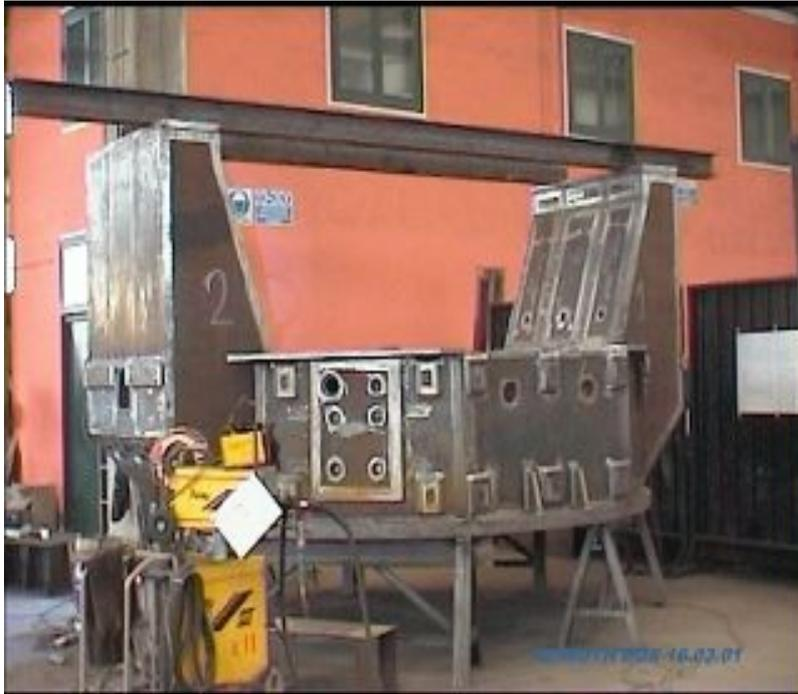
**Fig.5.b – L'AZ BOX in fase di completamento (carpenteria)**
