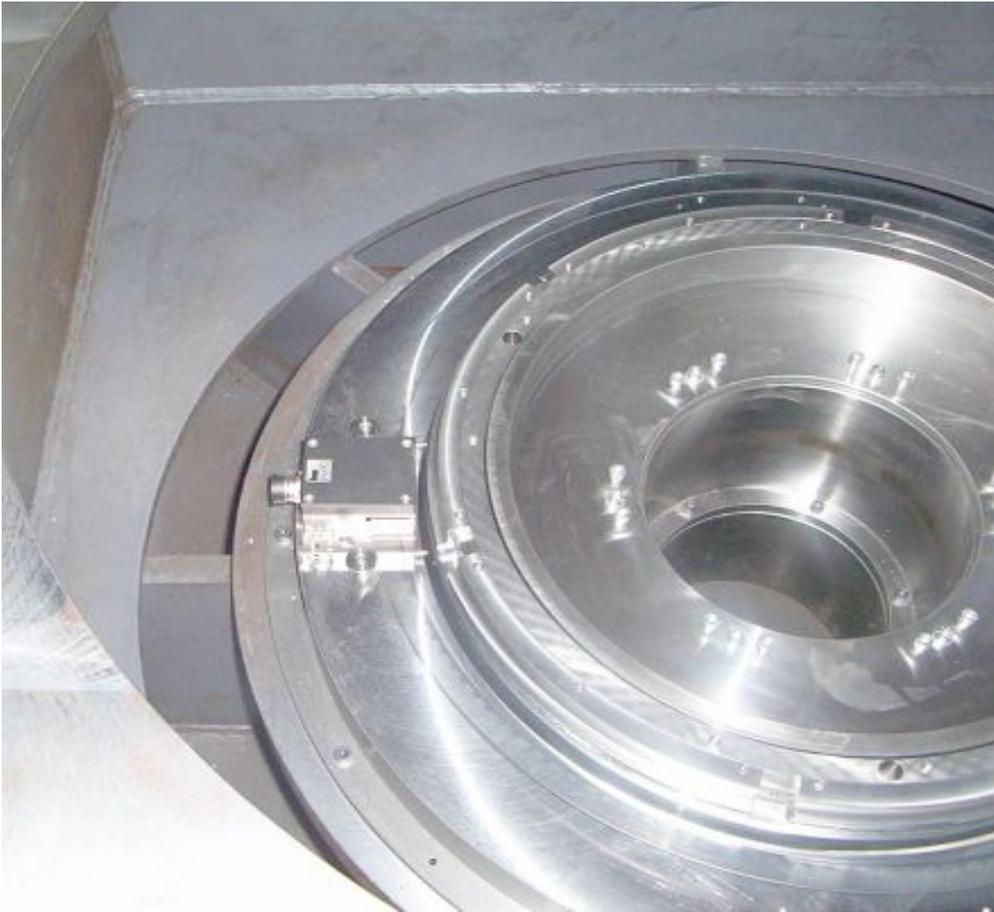
Alcuni particolari dell'encoder di azimuth.
