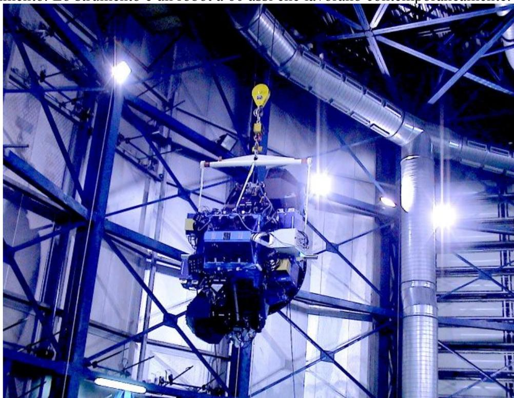
Lo strumento sospeso nella cupola dell'unità VLT#3 Melipal poco prima di essere fissato alla flangia strumenti del telescopio.
