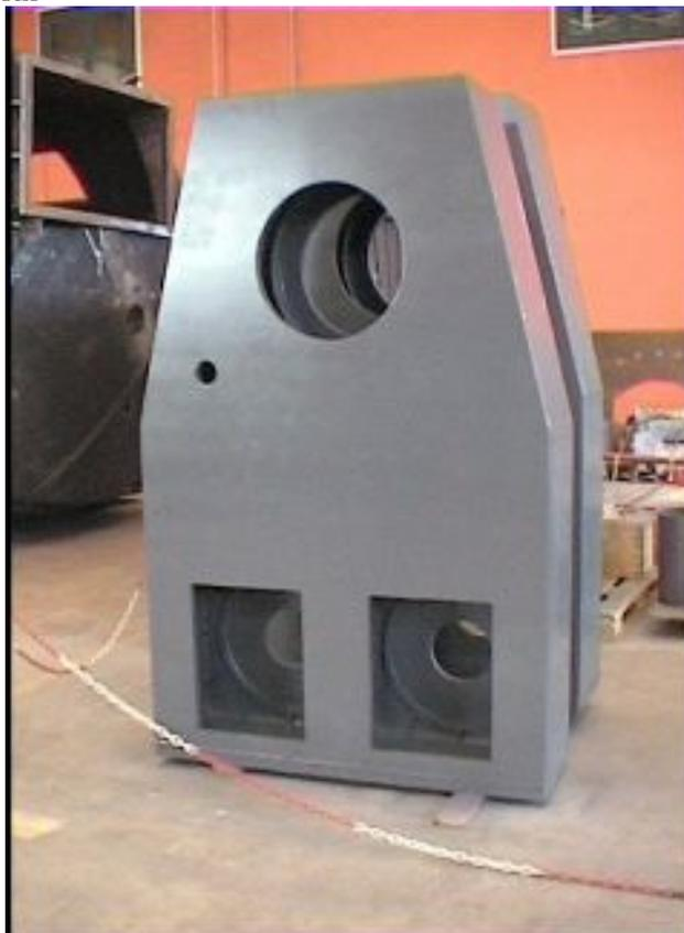
**Fig.5.a – Gli arm completati in carpenteria**
