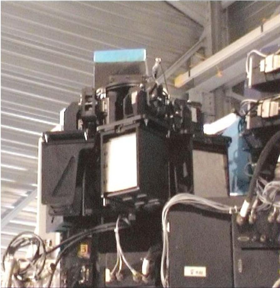
**Fig.4b – Lo spettrografo VIMOS durante la fase di integrazione a OHP in una foto di Marzo 2001. E' visibile una delle unita' GEU completa dei dummies del grisms. Ogni blocco grism ha un peso di circa 14 kg.**
