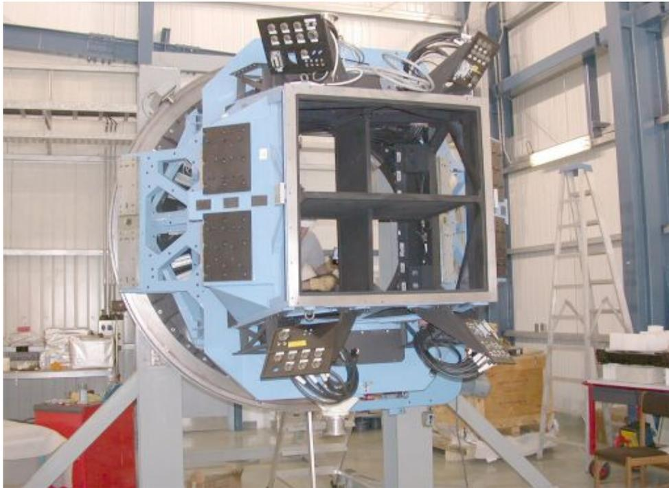
Una delle immagini della fase di integrazione. La struttura completa di tutte le interfacce verso i dispositivi. Lo spettrografo a quattro canali consente di realizzare fino a 1000 spettri contemporaneamente.
