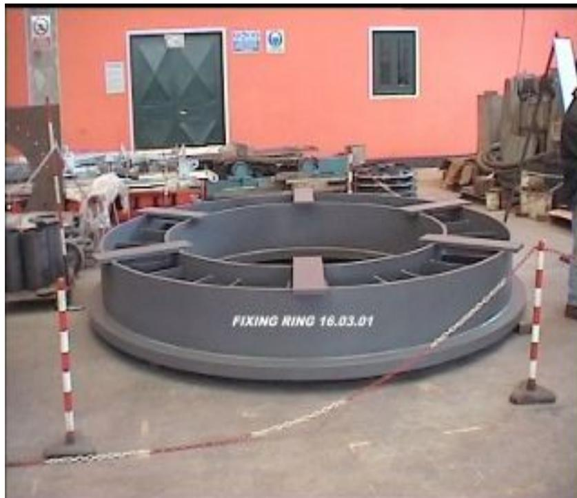
**Fig.5.e – Il fixing ring completato (carpenteria)**
