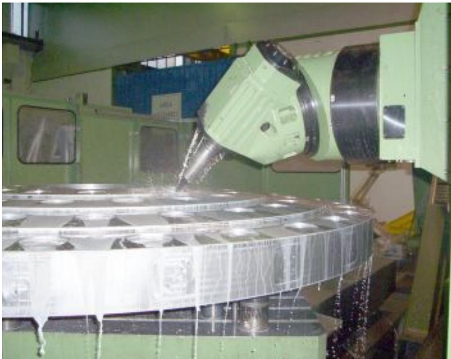
Una fase di lavorazione del simulacro di M1. E' stato rilavorato dopo il disastro del primo specchio primario di VST.
