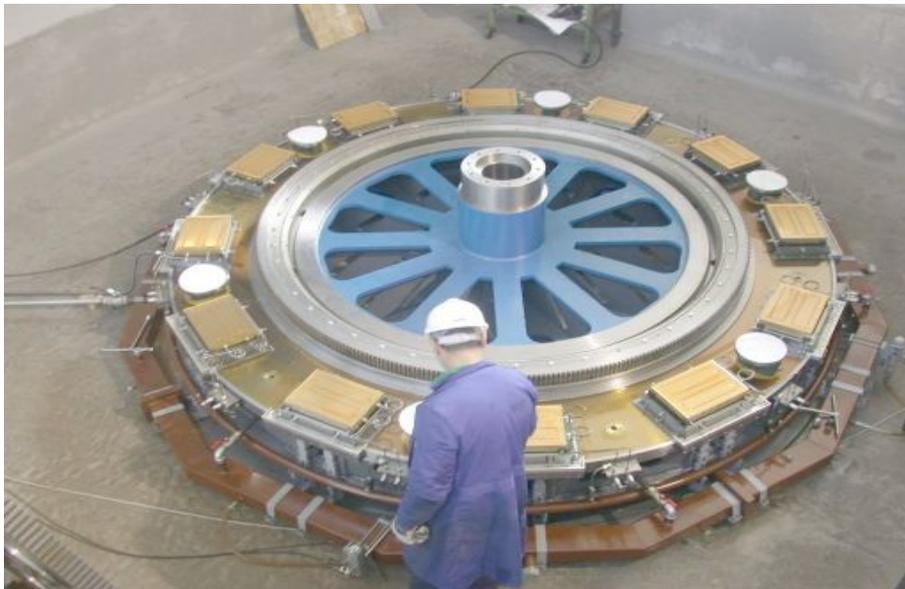
Il sistema di supporto idrostatico in azimuth.
