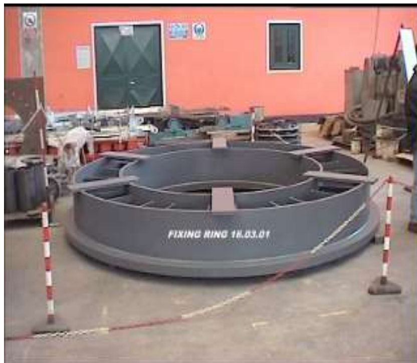
Fig.5.e – Il fixing ring completato (carpenteria)
