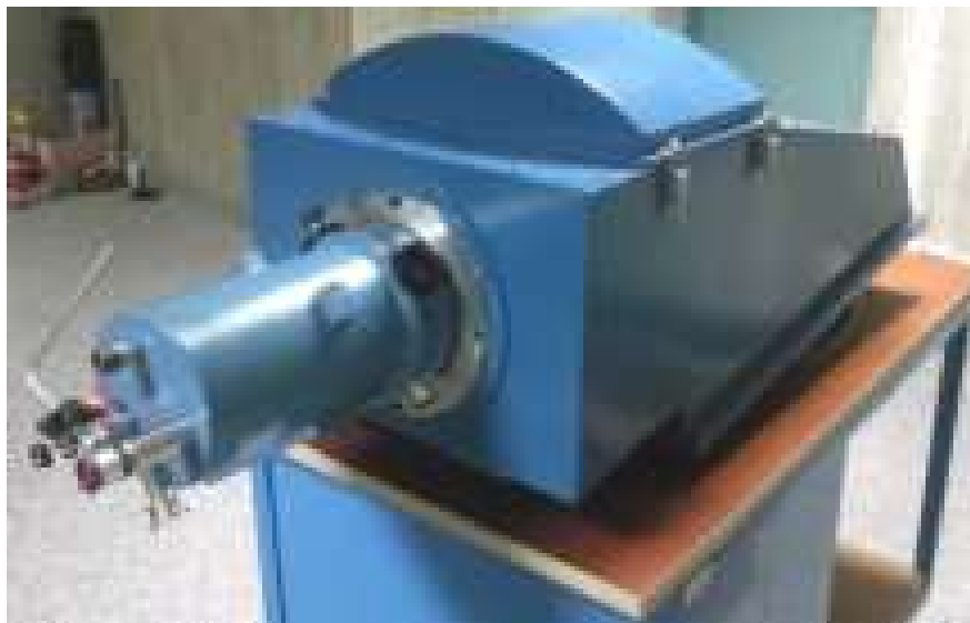
Integrazione del Dewar allo spettrografo TFOSC modificato all'occorrenza (2010-2011)
