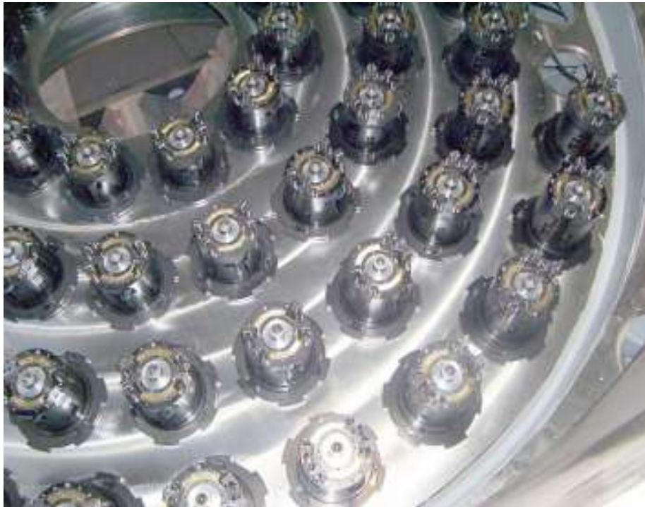
Gli attuatori assiali del sistema di ottica attiva del VST. 84 attuatori assiali sostengono lo specchio primario.
