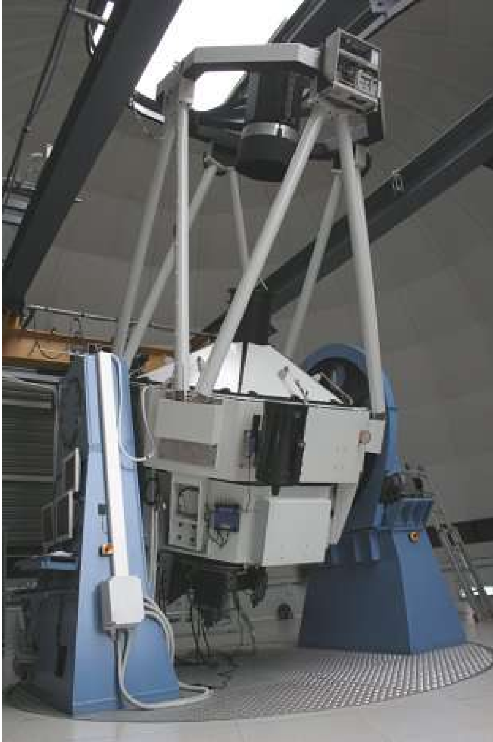
Il telescopio TT1 integrato in cupola (2010) con la camera CCD al fuoco Cassegrain
