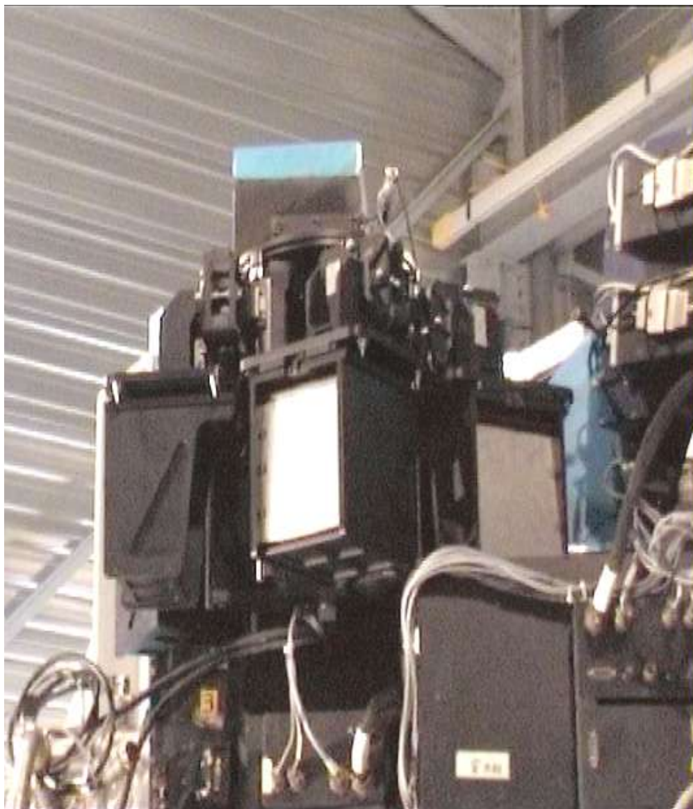
Fig.4b – Lo spettrografo VIMOS durante la fase di integrazione a OHP in una foto di Marzo 2001. E' visibile una delle unita' GEU completa dei dummies del grisms. Ogni blocco grism ha un peso di circa 14 kg.
