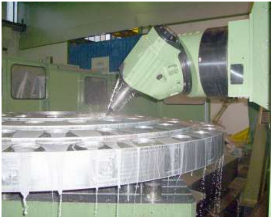
Una fase di lavorazione del simulacro di M1. E' stato rilavorato dopo il disastro del primo specchio primario di VST.
