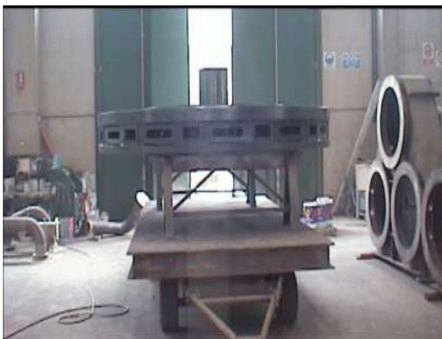
Fig.5.d – Il baseplate completato (carpenteria)
