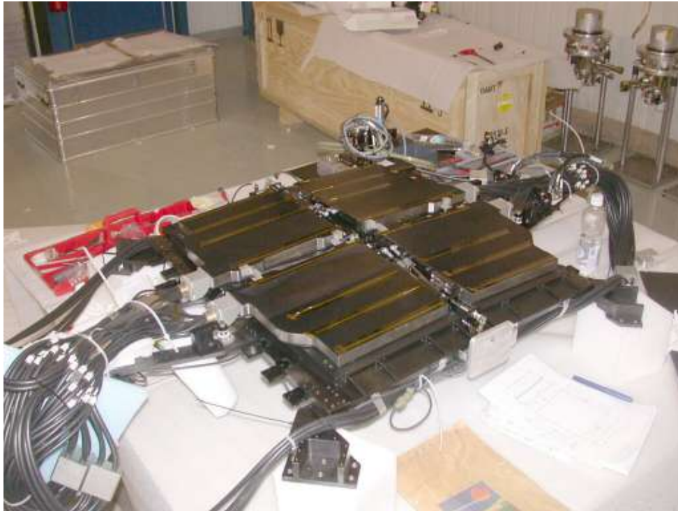
Il piano focale del VIMOS preparato su un banco per la taratura prima del montaggio nell'strumento. Si notano i fasci di fibre dell'unità IFU (a sinistra).
