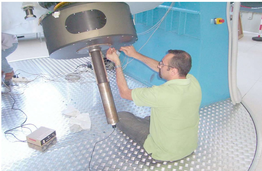
Un collaboratore di Mancini (F. Cortecchia) durante la fase di messa a punto ed allineamento delle ottiche mediante sistema SH e laser di riferimento (2007-2008)
