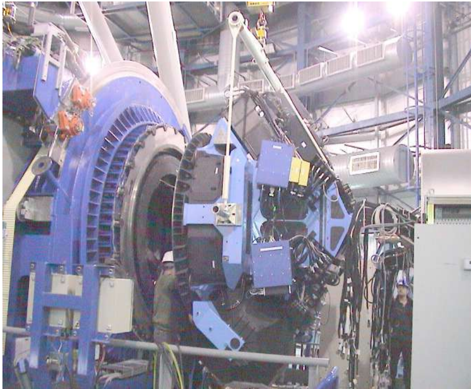
Lo strumento durante la fase di fissaggio alla flangia strumenti del VLT.
