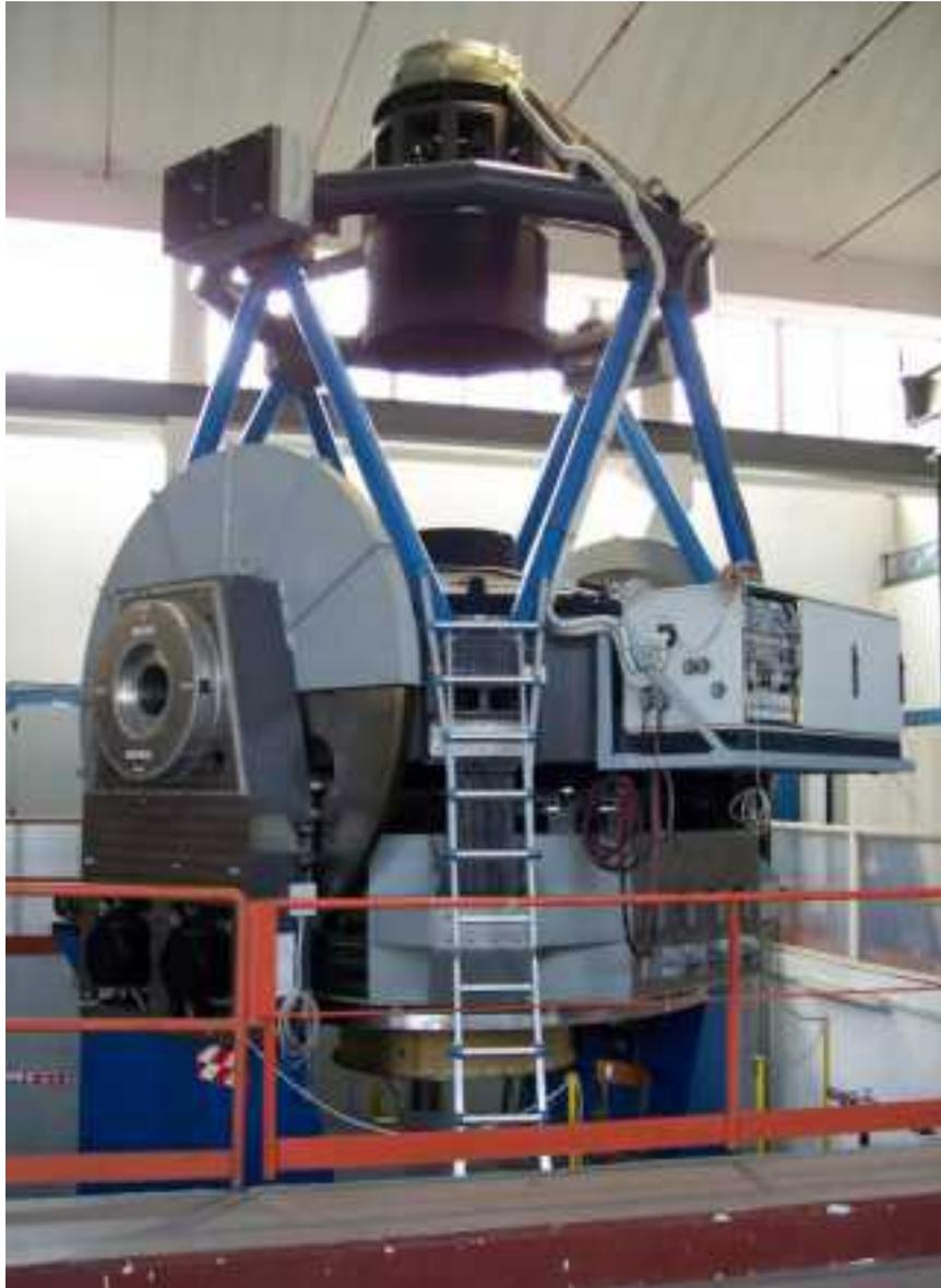
**Il telescopio assemblato in officina nel 2005 dopo il montaggio dei quadri di controllo della sezione ottica attiva e focal plane. Sono visibili anche i pesi di bilanciamento, l'hexapode ed i quadri di controllo dell'ottica attiva. Questi sono stati direttamente montati al center piece per assecondare la moltitudine di cavi in transito tra quadri ed unità controllate. Sono visibili anche due dei motori di ALT, l'encoder di ALT e il dummy di Omegacam al fuoco Cassegrain.**
