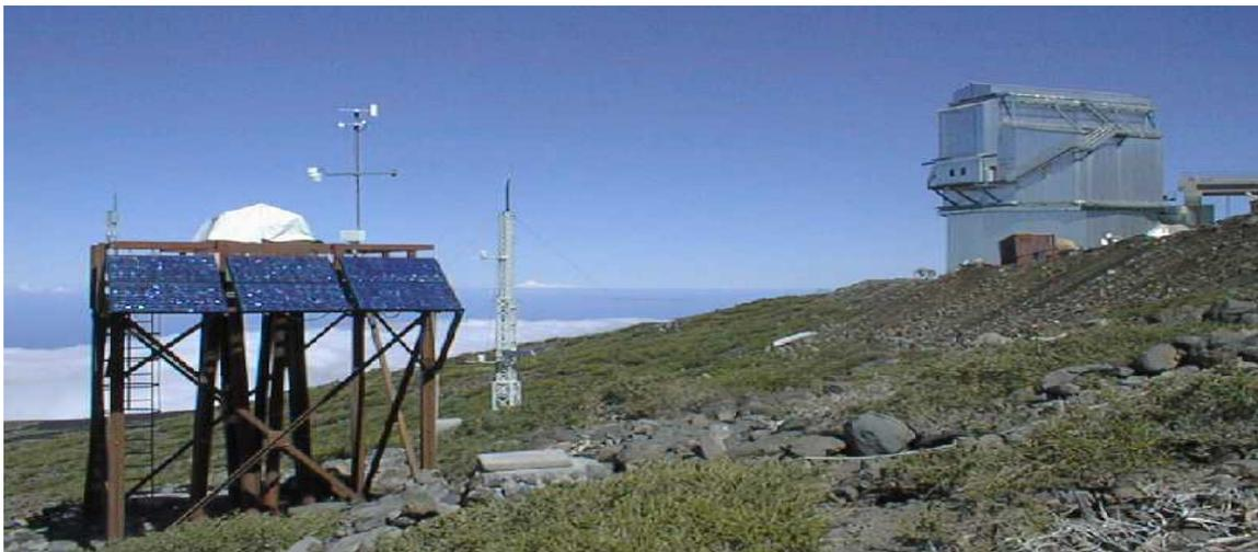
**Fig.3 - La torre di supporto del DIMM con gli ausiliari installati (meteo, modem, solar panel). Sullo sfondo la torre meteo del TNG, e sulla destra il building del TNG.**
