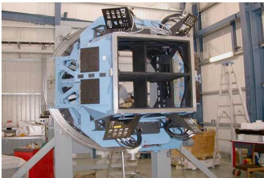
Una delle immagini della fase di integrazione. La struttura completa di tutte le interfacce verso i dispositivi. Lo spettrografo a quattro canali consente di realizzare fino a 1000 spettri contemporaneamente.
