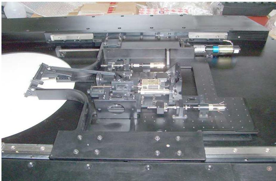
Uno dei sottoassiemi del telescopio. La meccanica del PROBE nell'area del focal plane.
