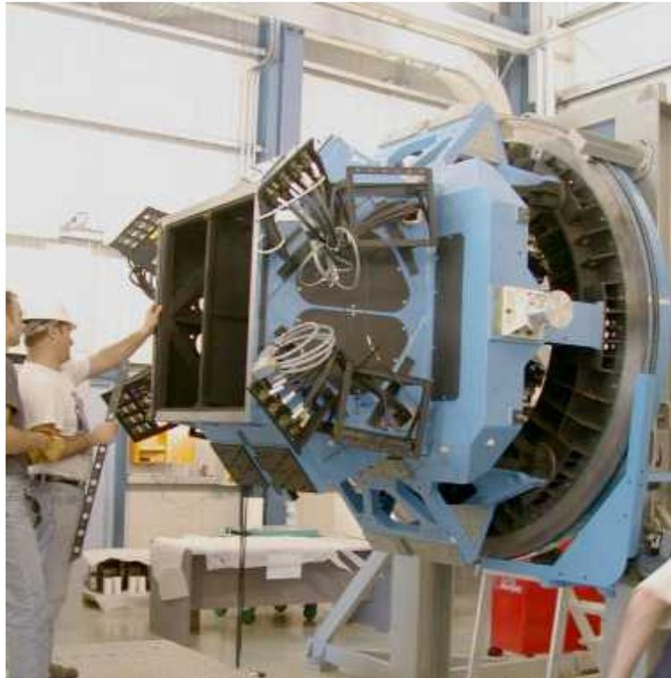
Durante la fase di integrazione lo strumento è stato fissato ad una flangia rotante simulante la flangia strumenti dell'unità VLT.
