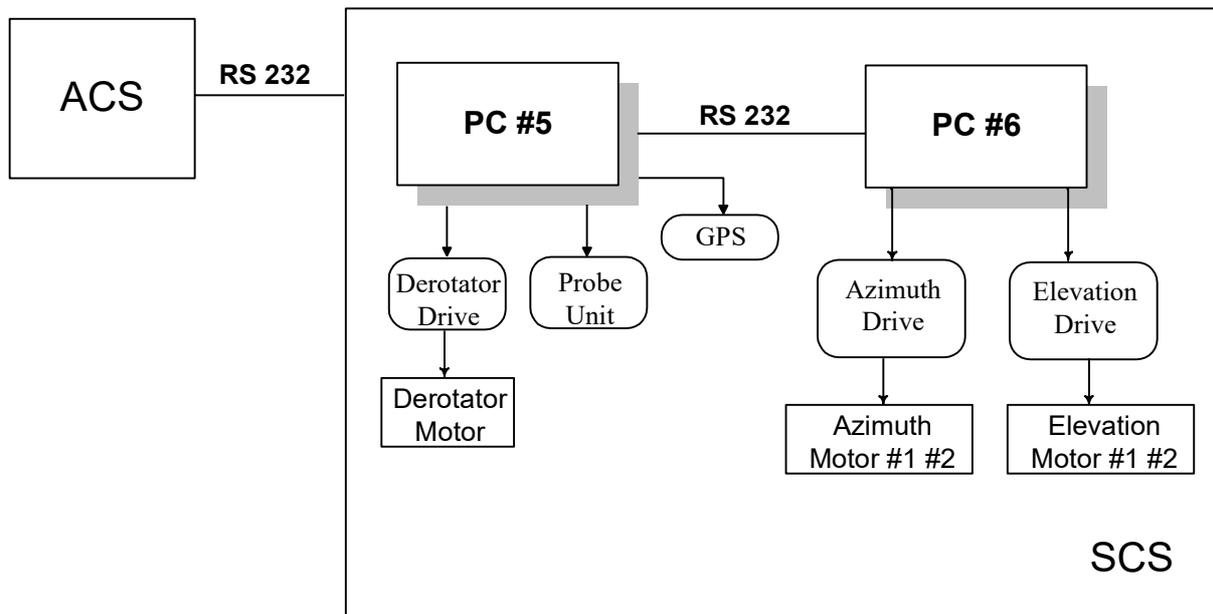
**Fig. 11 – Sistema di controllo sincrono (SCS)**
