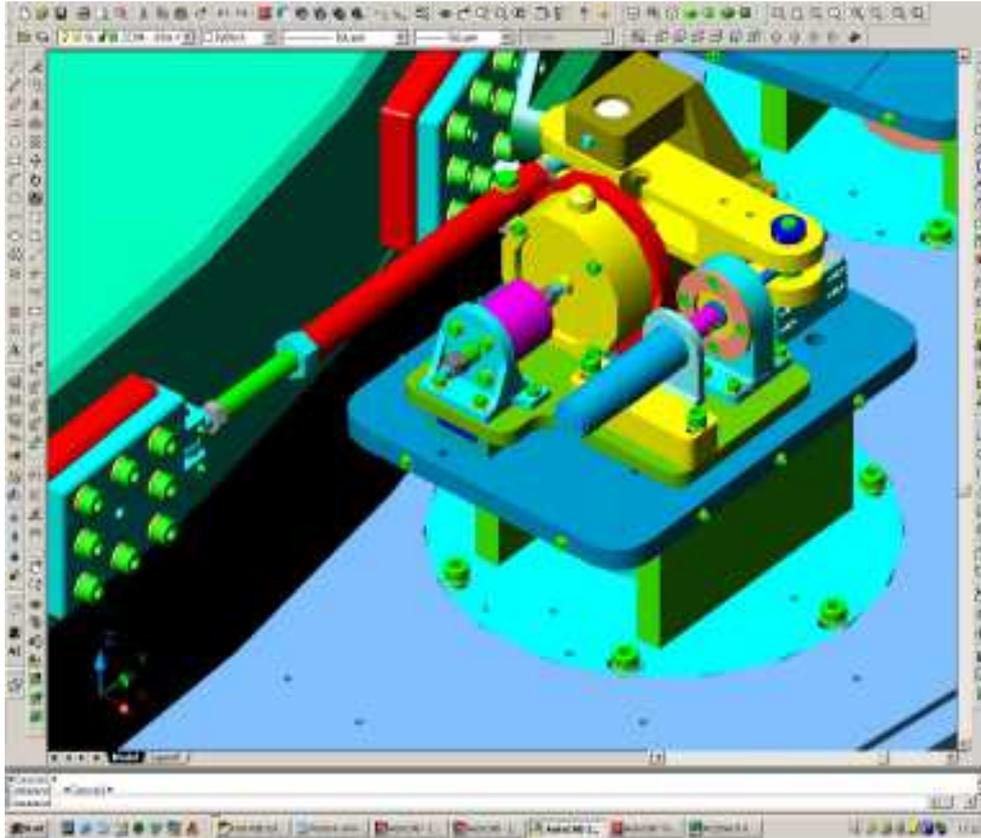
Una delle fasi di studio del sistema di supporto radiale dello specchio primario.
