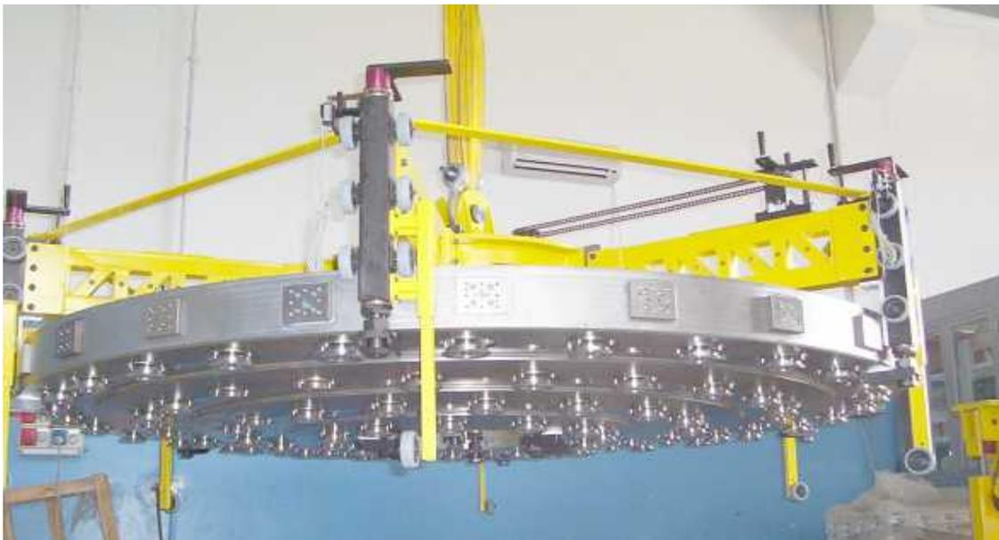
Il simulacro di M1 trasportato per mezzo del M1 handling device che ne consente la manipolazione, così come consente la manipolazione dello specchio reale. Dotato di sensori di carico per la corretta ripartizione delle reazioni vincolari degli appoggi.
