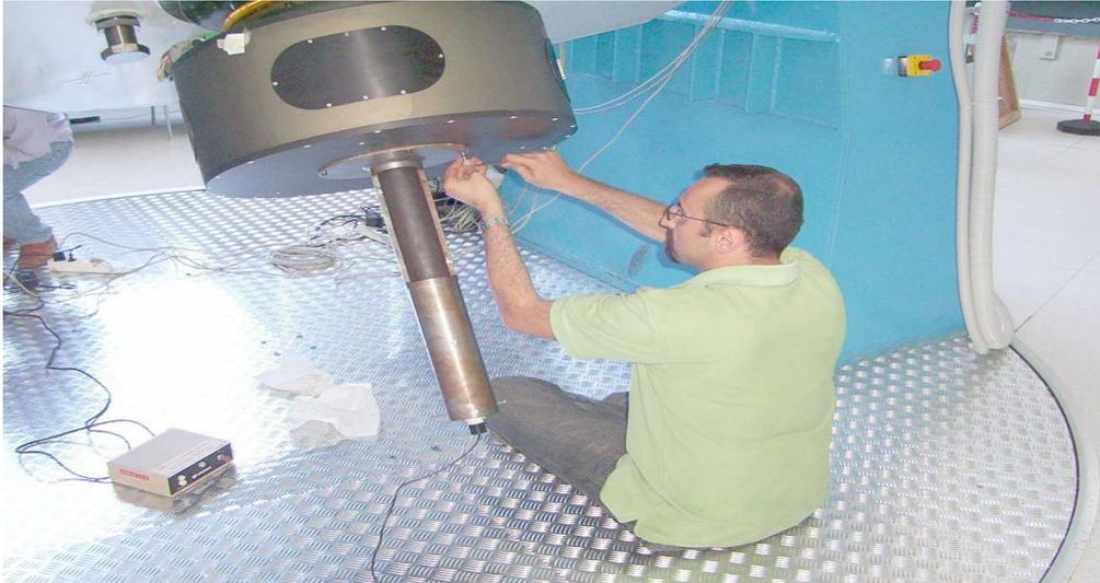
Un collaboratore di Mancini (F. Cortecchia) durante la fase di messa a punto ed allineamento delle ottiche mediante sistema SH e laser di riferimento (2007-2008)
