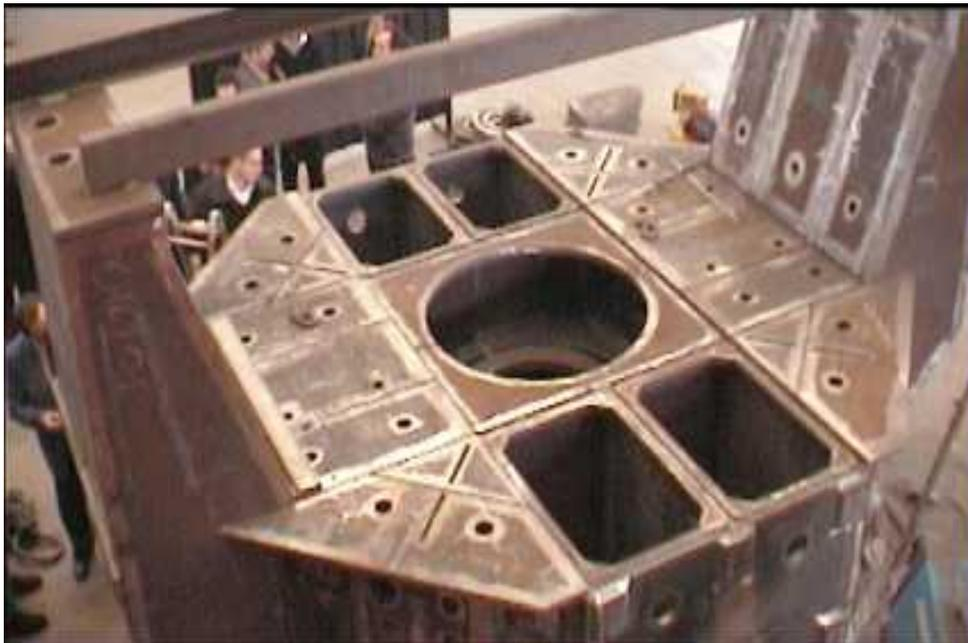
**Fig.5.c – L'AZ BOX in fase di completamento (carpenteria)**
