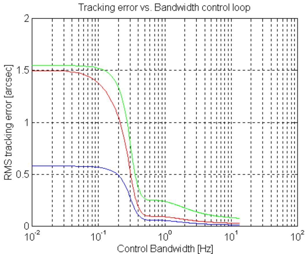
**Fig.4 - Dipendenza dell'errore di tracking in funzione della banda passante del sistema di controllo e considerando lo spettro del vento proprio del Paranal. Le tre curve sono state calcolate considerando fattori di attenuazione differenti. La curva più alta è calcolata in assenza di attenuazione, con telescopio in aria aperta. La seconda (intermedia) è calcolata considerando un fattore di attenuazione**
