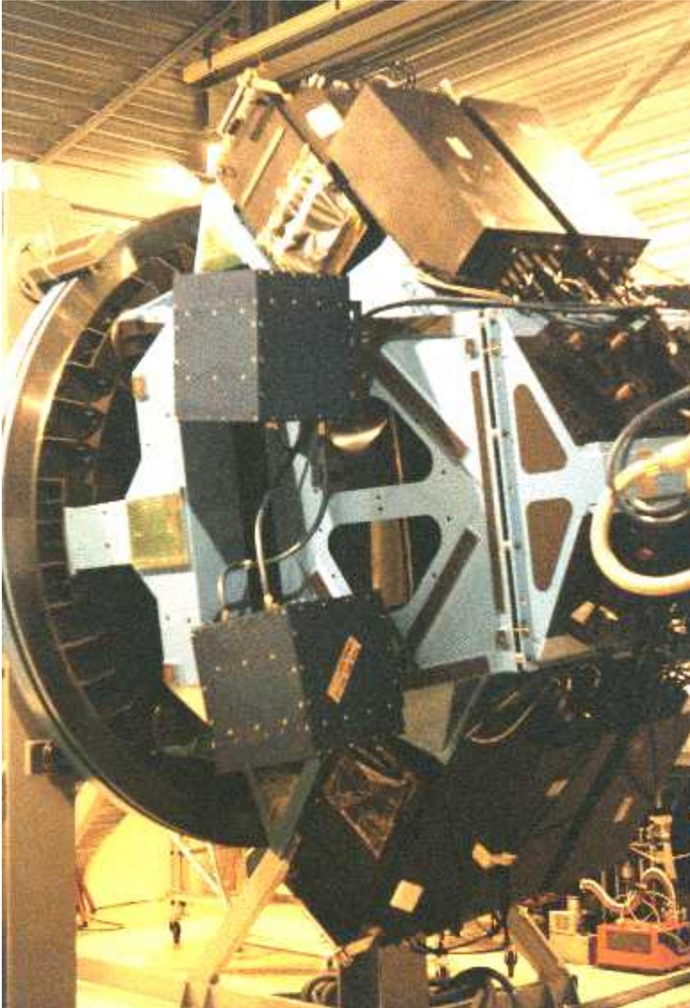
**Fig.4a – Lo spettrografo VIMOS durante la fase di integrazione a OHP in una foto di ottobre 2000. Sono visibili tutte le unita' (FEU, OB, FM, FOCUS, PRL (all'interno), MEU (posteriore). Manca la sola unita' GEU attualmente installata e testata (manca foto digitale).**
