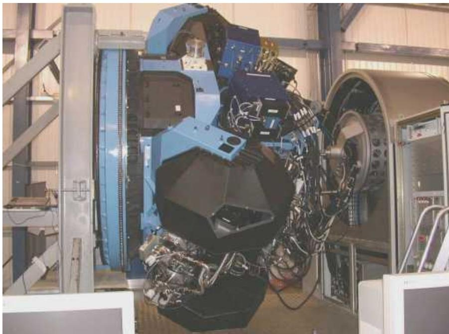
Lo strumento è fissato ad un'unità di corotazione che ha lo scopo di accompagnare nella rotazione e senza stress meccanici l'immensa quantità di cavi che parte dallo strumento. Lo strumento è un robot a 60 assi che lavorano contemporaneamente.
