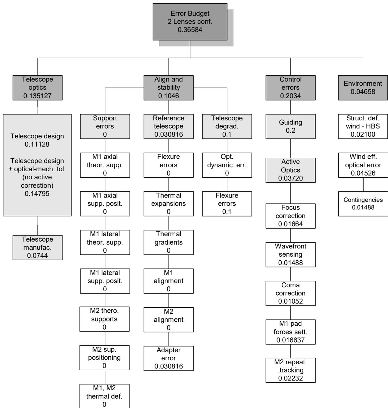
**Fig.3 – Tabella riportante l’error budget nel caso di correttore a due lenti. Raggio dello spot RMS a Z=0°. Le unità sono in arcosecondi. I calcoli sono stati effettuati con 11% del tempo con vento oltre i 12 m/s.**
