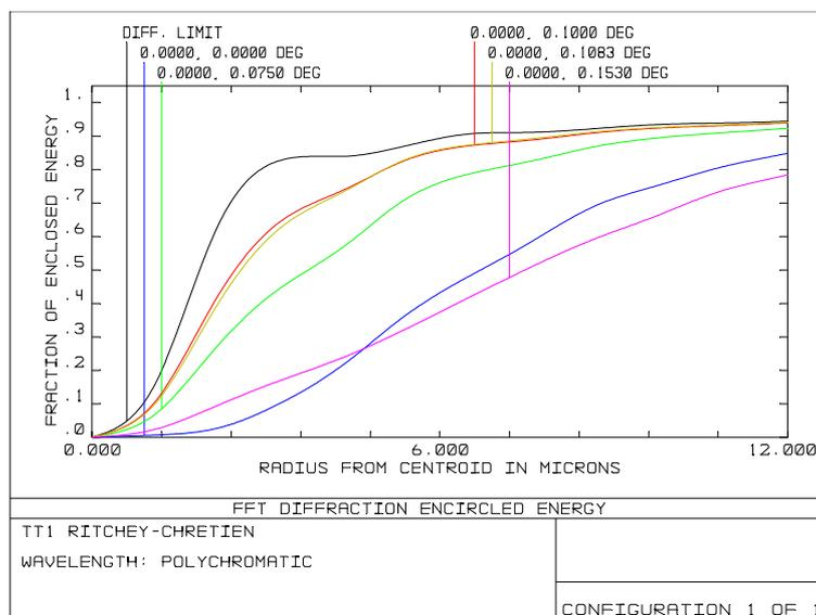
**Fig. 6 - Curve della frazione d'energia diffrazionale contenuta in un *pixel* di 24  $\mu\text{m}$  per i campi coperti dal CCD**
