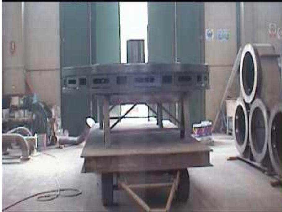
**Fig.5.d – Il baseplate completato (carpenteria)**
