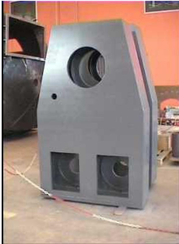
**Fig.5.a – Gli arm completati in carpenteria**
