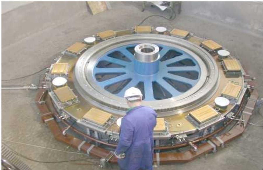
Il sistema di supporto idrostatico in azimuth.
