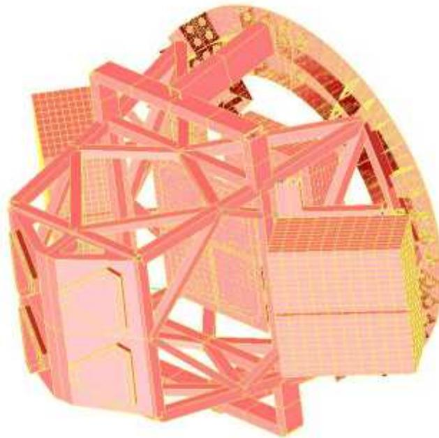
**Fig.4d– Il modello strutturale del VIMOS per l’analisi agli elementi finiti**
